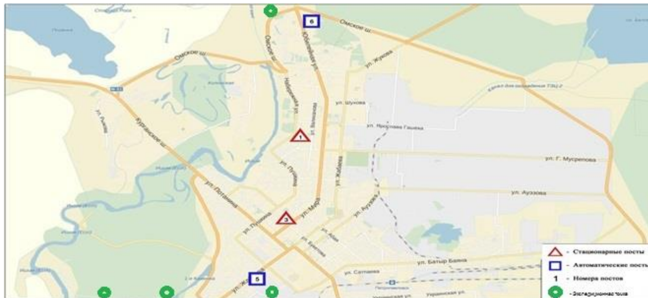
Рис.1 – Схема расположения стационарной сети наблюдения за загрязнением атмосферного воздуха СКО
