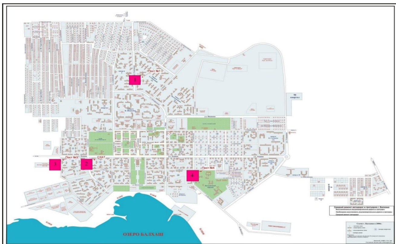
8.2 сур. Балқаш қаласының атмосфералық ауа ластануын бақылау стационарлық желісінің орналасу сызбасы
