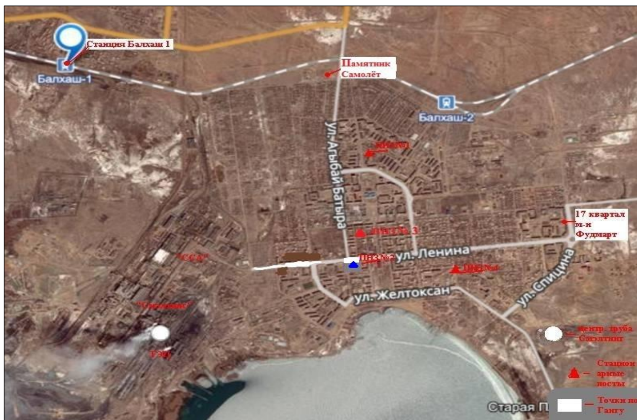
Схема расположения стационарной сети наблюдений за загрязнением атмосферного воздуха города Балхаш
